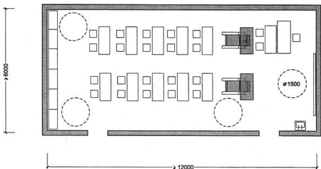
**Рисунок Б.3 - Варианты планировочных решений классных помещений площадью 60-70 м<sup>2</sup>**
