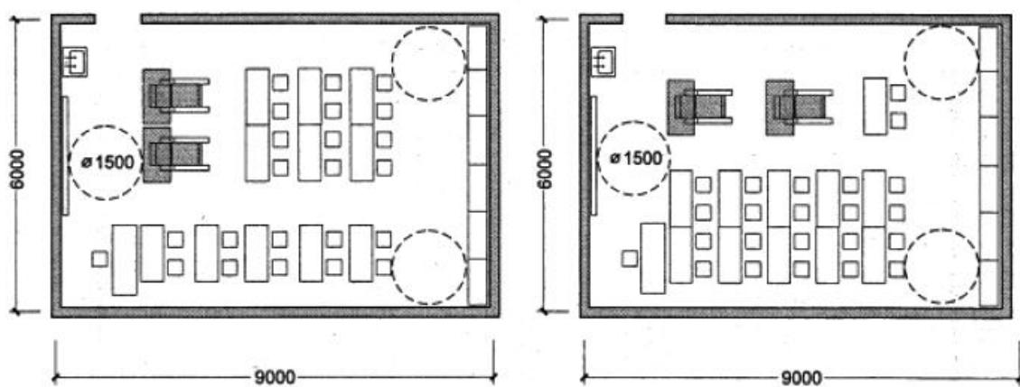
**Рисунок Б.2 - Варианты планировочных решений классных помещений площадью около 50 м<sup>2</sup>**
