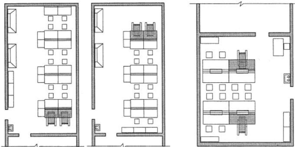
**Рисунок Б.4 - Примеры расстановки оборудования в аудитории и лабораториях химии и физики**
