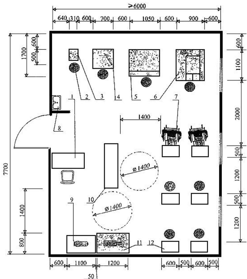
1 - стол мастера; 2 - табурет с регулируемым сиденьем; 3 - машина для приклейивания каблуков; 4 - пресс для приклеивания подошв; 5 - машина для отделочных операций; 6 - машина для пристрочки подошв; 7 - рабочее место инвалида; 8 - мойка; 9 - швейная машина; 10 - шарошечно-полировальный станок; 11 - верстак; 12 - стол обувщика
