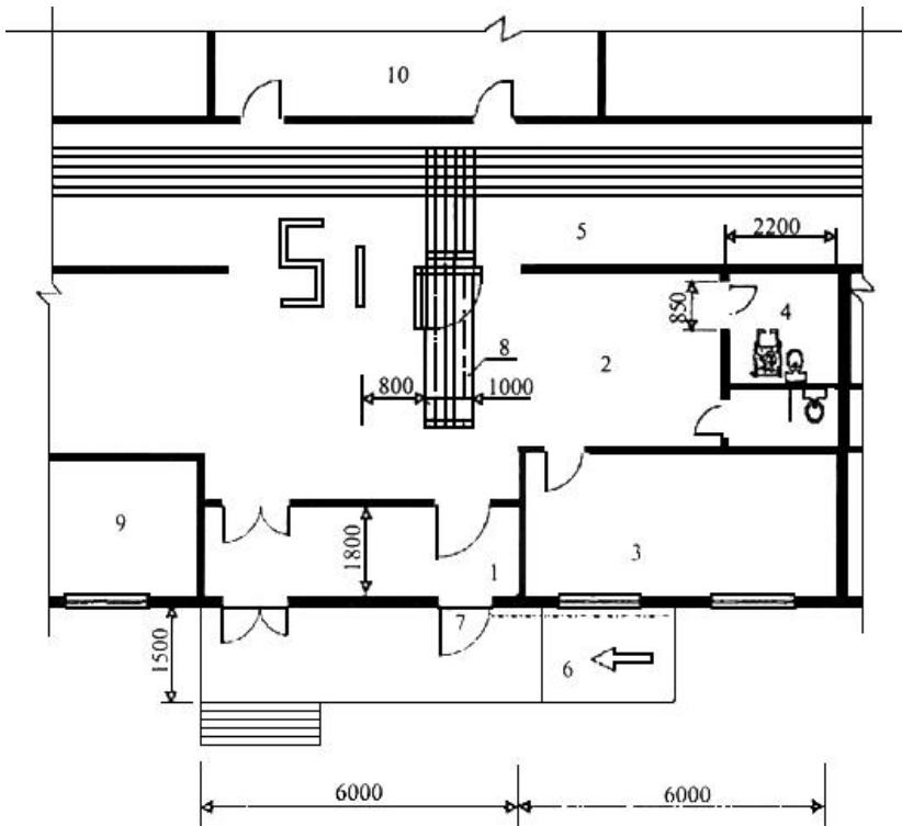
1 - тамбур; 2 - вестибюль; 3 - камера хранения; 4 - санузел; 5 - коридор; 6 - пандус; 7 - дверной проем с устройством для плавного открытия; 8 - специальное покрытие пола; 9 - бюро пропусков; 10 - помещения охраны
