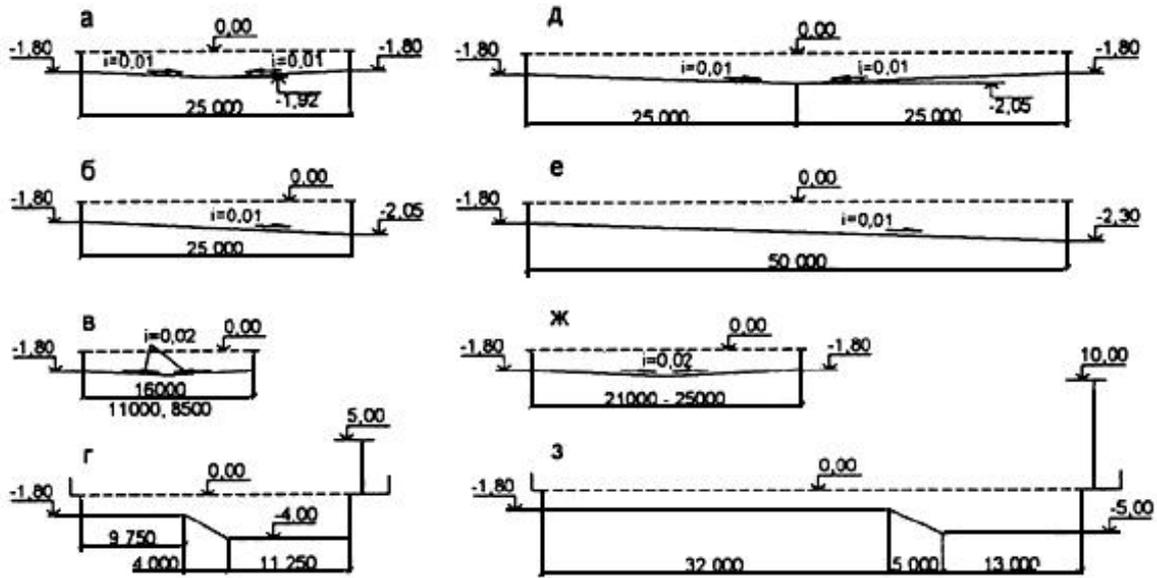
а — 25-метровая ванна для спортивного плавания с двусторонним продольным уклоном; б — то же, с односторонним продольным уклоном; в — то же, с двусторонним поперечным уклоном; г — 25-метровая универсальная ванна с вышкой для прыжков высотой 5 м; д — 50-метровая ванна для спортивного плавания с двусторонним продольным уклоном; е — то же, с односторонним продольным уклоном; ж — то же, с двусторонним поперечным уклоном; з — 50-метровая универсальная ванна с вышкой для прыжков высотой 10 м
