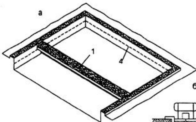
1 — передвижная плавающая перегородка, отделяющая часть бассейна; 2 — съемные перила; 3 — съемные стартовые тумбочки; 4 — уровень воды; 5 — решетки диаметром 300 мм для циркуляции воды; 6 — литые маркеры для разметки дорожек
