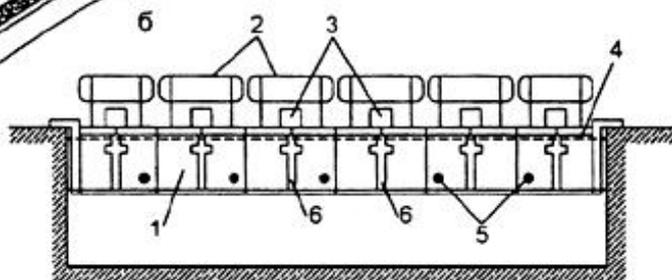
а — общий вид плавающей перегородки, отделяющей часть бассейна; б — поперечный разрез бассейна с плавающей перегородкой
