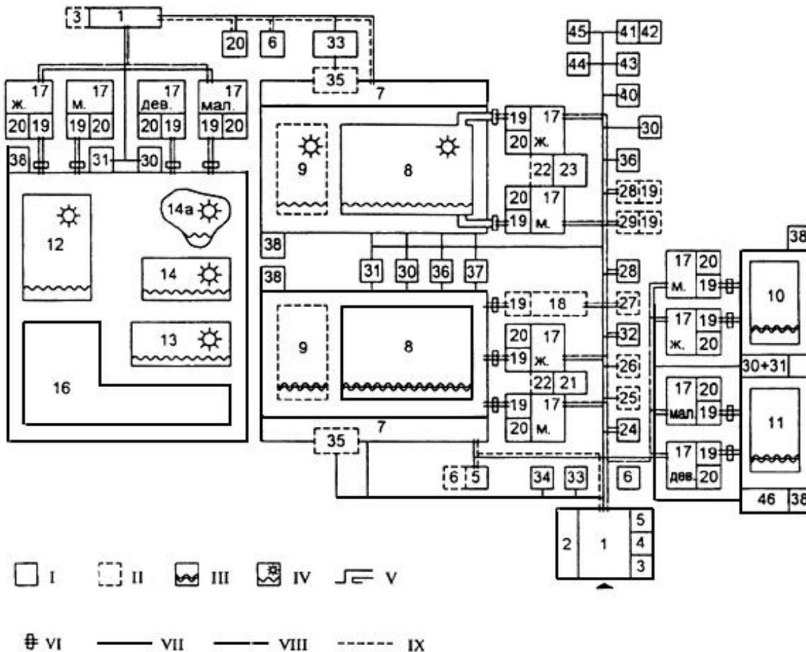
I — помещения и сооружения основного состава; II — помещения и сооружения дополнительного состава; III — крытая ванна; IV — открытая ванна; V — выплыв; VI — проходной ножной душ; VII — функциональная связь; VIII — движение занимающихся; IX — движение зрителей
