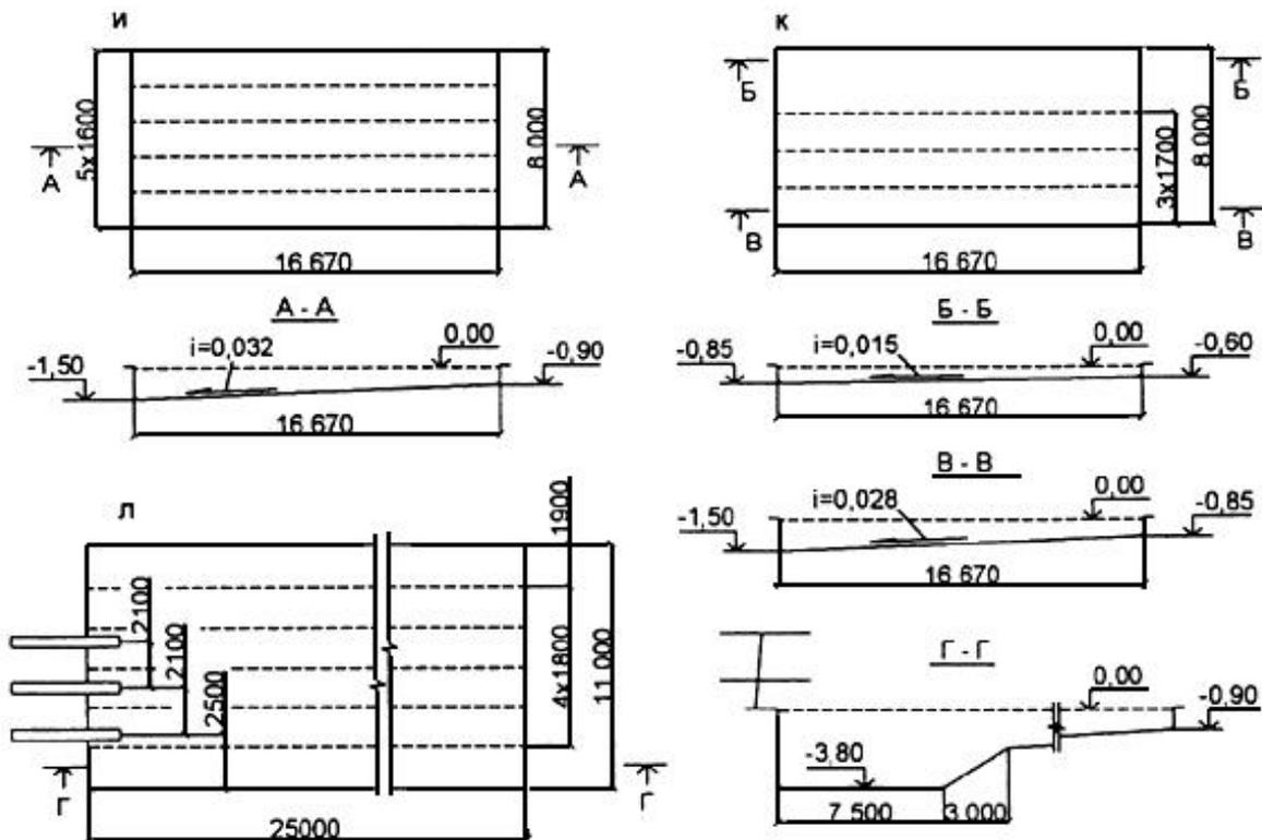
и — ванна 16,6x8 м; к — ванна 16,6x8 м с различной глубиной; л — ванна 25x11 м с прыжковыми устройствами
