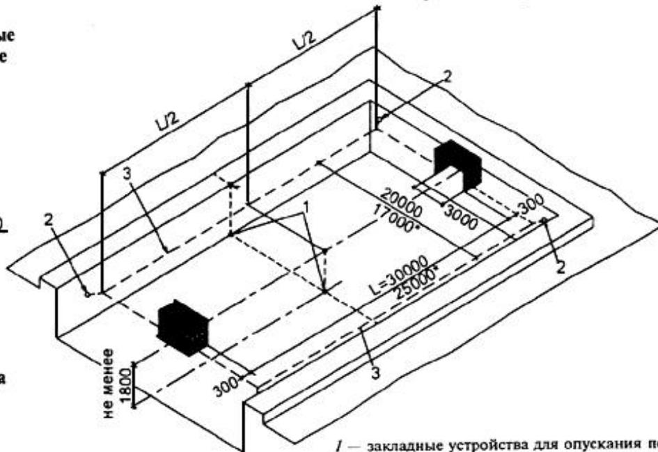
1 — закладные устройства для опускания поплавка под мяч на дно; 2 — крюки в бортике для крепления плавучей разметки границ поля; 3 — граница игрового поля
