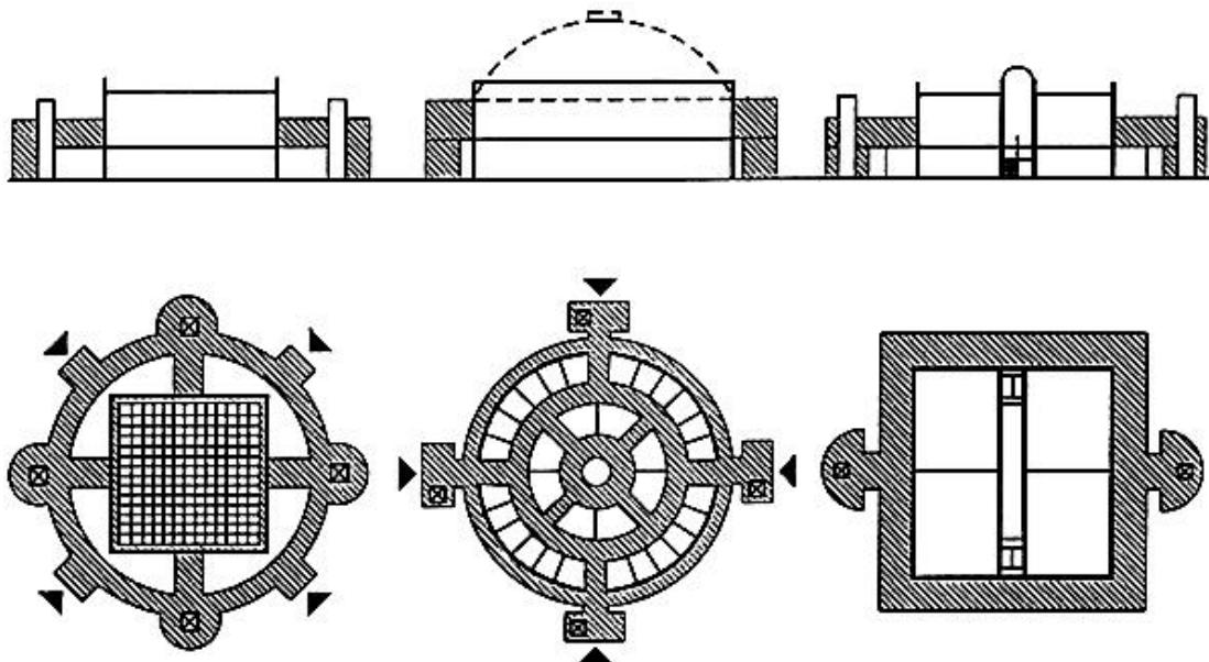
Методом строительства отдельно стоящих входных и лифтовых узлов с круговой обходной галереей при сохранении фронта естественного освещения Реконструируемого здания
