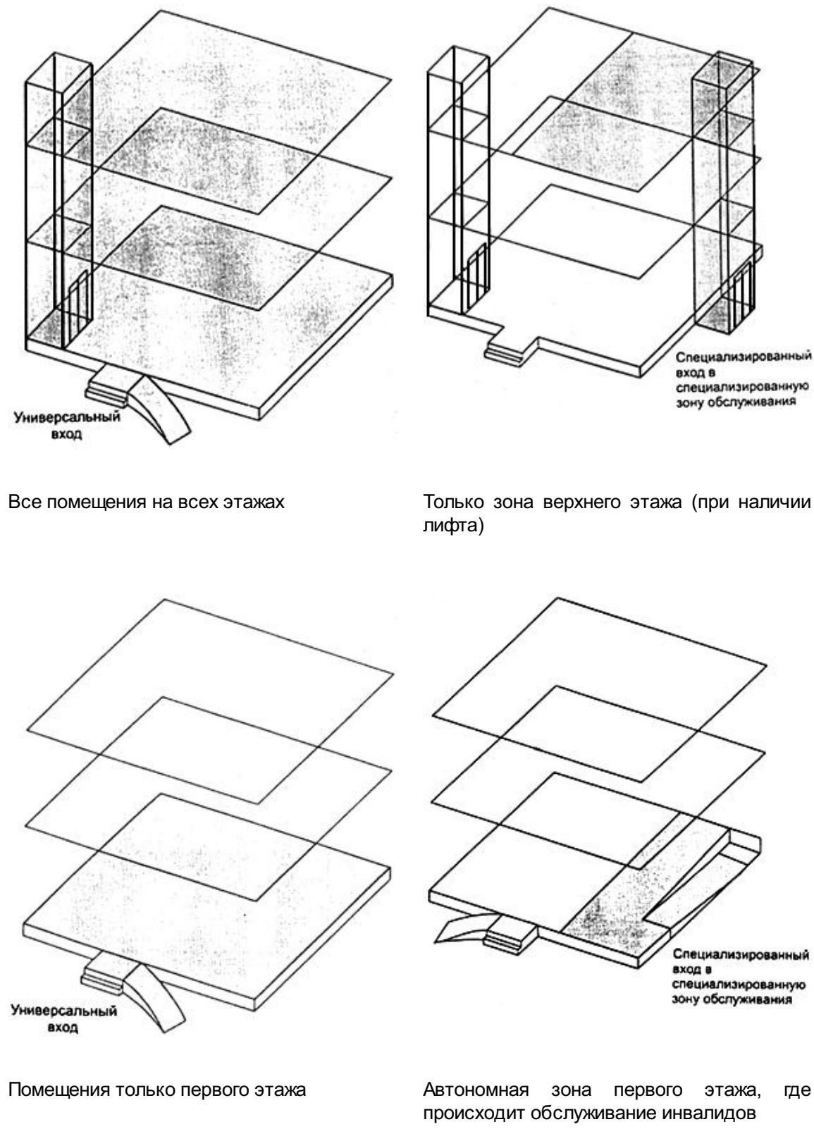
Рис.1.2. Обеспечение доступности при реконструкции
