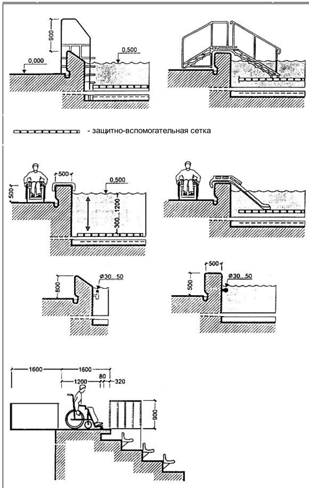
**Рис.5.3. Плавательные бассейны. ОБОРУДОВАНИЕ
