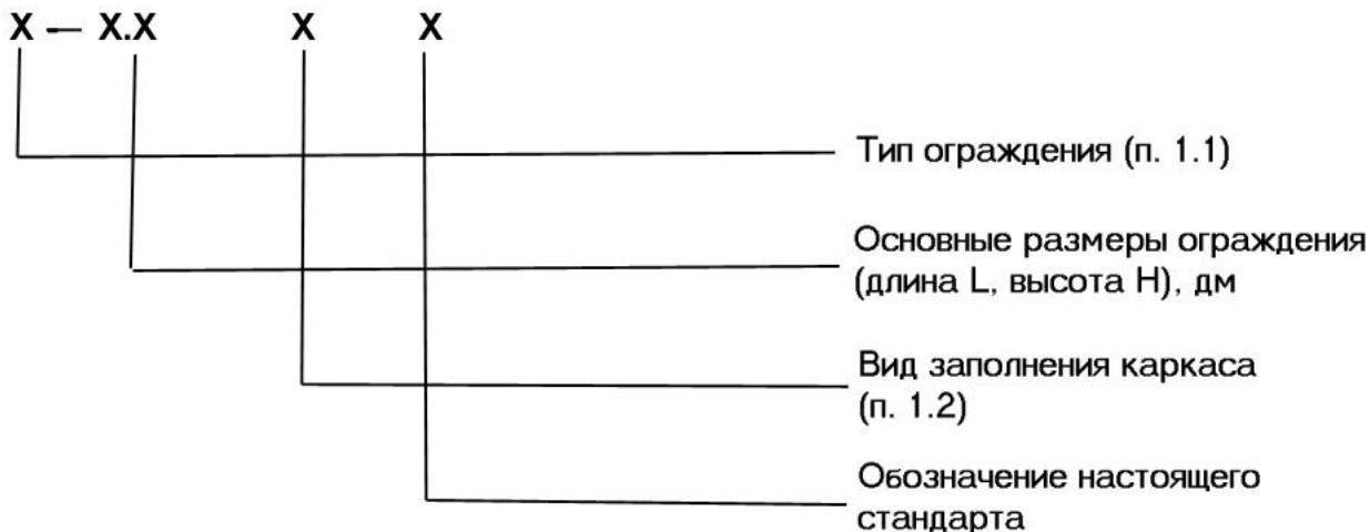
Пример условного обозначения марки ограждения лестничного марша внутренней лестницы длиной 2700 и высотой 900 мм, решетчатого:
