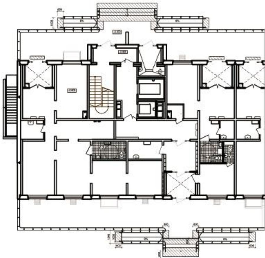
Рисунок А.2, лист 1 - Варианты решений первого этажа в жилых домах нового строительства без перепада между вестибюльно-входной группой и входом в лифты: рядовая блок-секция (а); угловая блок-секция (б)
