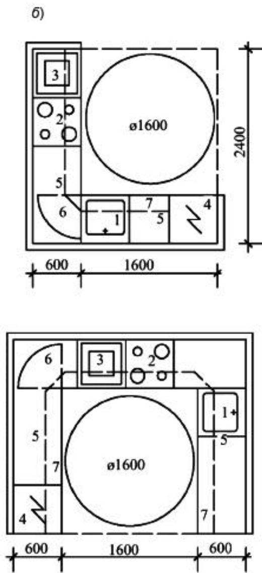
1 - мойка консольного типа; 2 - электроплита консольного типа; 3 - жарочный шкаф настольный; 4 - холодильник; 5 - полки навесные; 6 - полки поворотные; 7 - стол консольный
