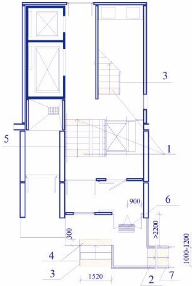
1 - контрастная маркировка нижней проступи ступени и верхней горизонтальной площадки завершения марша (ширина 60-300 мм);
